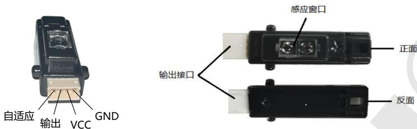
接口说明: 输出接口1.5mm间距 4PIN, 接口定义: GND (电源负)、VCC(电源正)、输出/TX/SDA(通信发射口)、自适应/RX/SCL(通信接收口);
